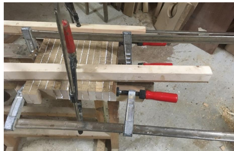
Slika 6: Z mizarскими sponami zlepljena igralna podlaga Vir: Lasten
